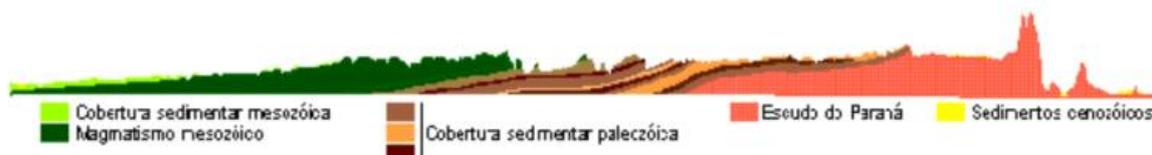
**Figura 3 - Perfil estratigráfico do estado do Paraná, direção sudeste-noroeste. Fonte: IAT, 2022.**
